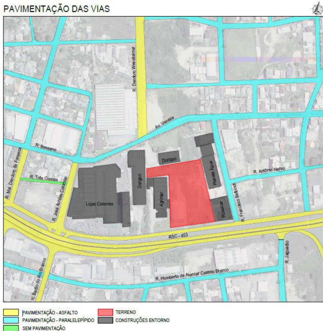
Figura 9 – Pavimentação das vias do entorno
