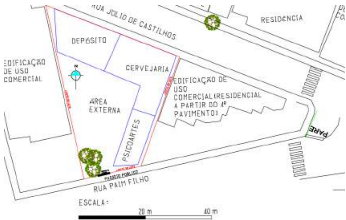
Figura 8 – Planta de situação.
