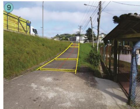
O acesso através da escada fica impossibilita para os PNEs, onde ela poderia ser substituída por uma rampa, em função da declividade.
