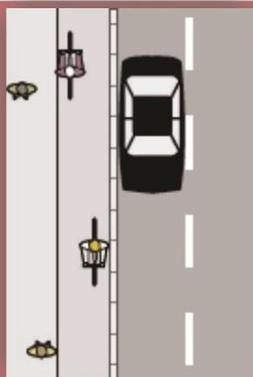
O sistema de **CICLOVIA** consiste em uma estrutura totalmente segregada do sistema viário e das áreas de passeio de pedestres, constituindo-se em um elemento de maior segurança para os deslocamentos dos ciclistas.
