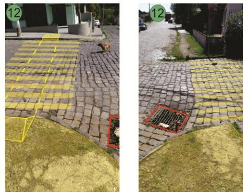
Falta de pavimentação da calçada e a falta de rampas dificultam a travessia de PNEs.
