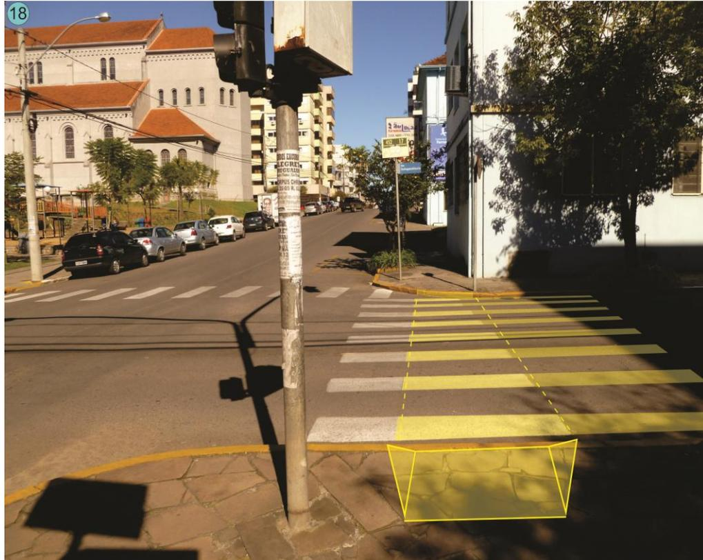
Falta de rampa para acessar a calçada e tamanho da faixa de pedestres inadequado.
