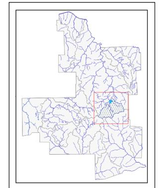
MAPA DIGITAL PLANIMÉTRICO ELABORADO PELO MÉTODO FOTOGRAMÉTRICO, ATRAVÉS DE RESTITUIÇÃO DE ORTOFOTOMOSAICO NA ESCALA 1/1.000. LEVANTAMENTO EXECUTADO EM 2018 PELO CONSÓRCIO CADASTRO FARROUPILHA: ENGEMAP - CADMAP - IMAGEM.
