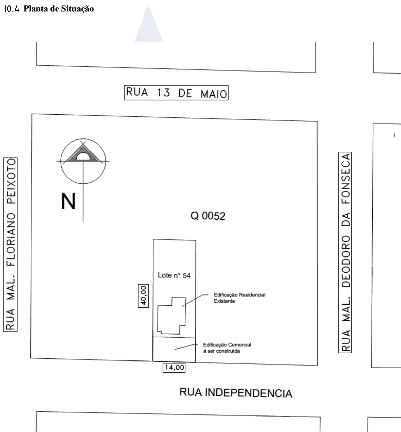
Figura 3. Planta de Situação
