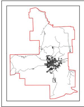
MAPA DIGITAL PLANIMÉTRICO ELABORADO PELO MÉTODO FOTOGRAMÉTRICO, ATRAVÉS DE RESTITUIÇÃO DE ORTOFOTOMOSAICO NA ESCALA 1/1.000. LEVANTAMENTO EXECUTADO EM 2018 PELO CONSÓRCIO CADASTRO FARROUPILHA: ENGEMAP - CADMAP - IMAGEM.
