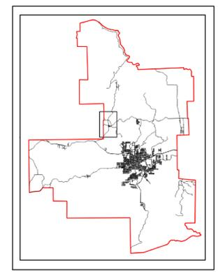
MAPA DIGITAL PLANIMÉTRICO ELABORADO PELO MÉTODO FOTOGRAMÉTRICO, ATRAVÉS DE RESTITUIÇÃO DE ORTOFOTOMOSAICO NA ESCALA 1/1.000. LEVANTAMENTO EXECUTADO EM 2018 PELO CONSÓRCIO CADASTRO FARROUPILHA: ENGEMAP - CADMAP - IMAGEM.
